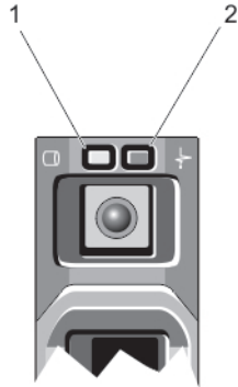
Ilustración 2. Indicadores de la unidad de disco duro
